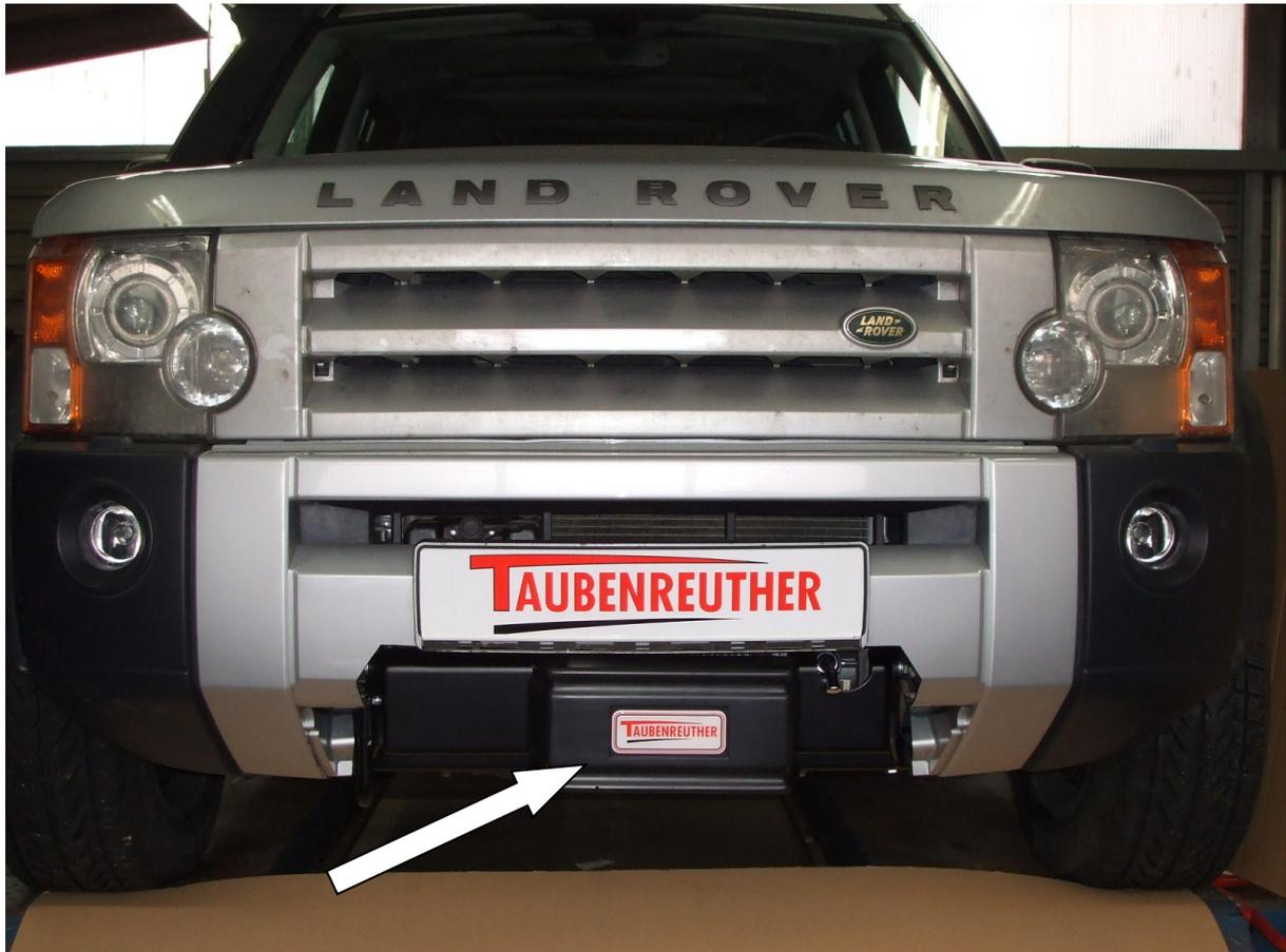
Hier sehen sie den fertig montierten Seilwindenanbausatz am Discovery 3.
